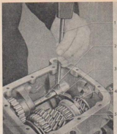
**Bild 98** Spannstift in Schaltgabel und Schaltstange einschlagen
