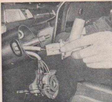
Bild 128 Lenk- und Zündschloß aus Lenkstützrohrverkleidung herausnehmen
