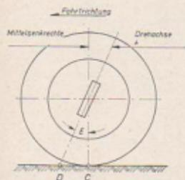
**Bild 129** Nachlauf: Die Drehachse bildet mit der Senkrechten zur Fahrtrichtung einen Winkel - die Drehachse ist oben nach hinten bzw. unten nach vorn geneigt. Ansicht von der Seite
