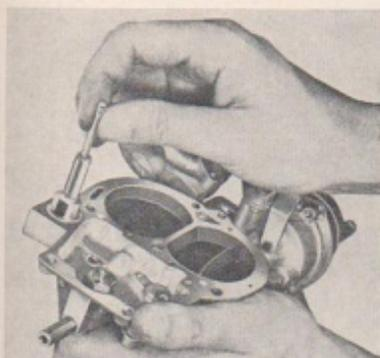
**Bild 57** Die Ventilstange des Belüftungsventiles wird auf Leichtigkeitsprüfung
