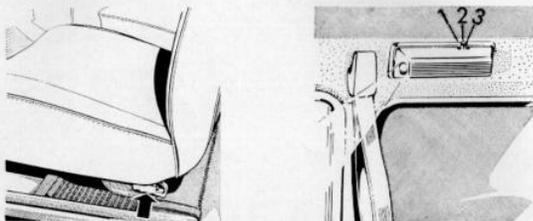
L'illuminazione interna s'inserisce automaticamente aprendo una porta, purché la levetta dell'interruttore della lampadina sia spostata in avanti.
