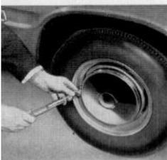
Nell'interesse della sicurezza di marcia e dell'efficienza della Vostra vettura dovrete attenervi alle seguenti raccomandazioni: la pressione dei pneumatici deve essere controllata almeno una volta alla settimana, ma sempre prima di iniziare un viaggio lungo. Il controllo va effettuato sui pneumatici **freddi** con un manometro di precisione.
