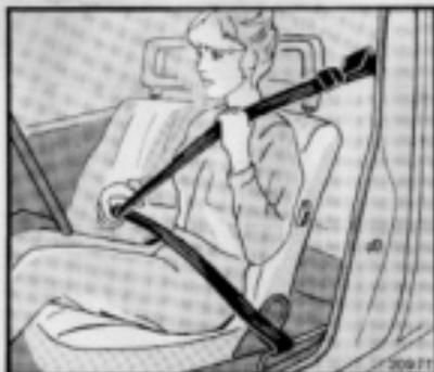
**Estrarre la cintura di sicurezza in modo progressivo e senza strappare dal rullo avvolgitore, farla passare sopra la spalla e inserire la linguetta di aggancio nella serratura**
